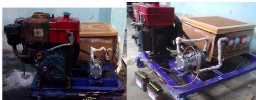
**Gambar 8. Model Mesin Pendingin Ikan Tangkapan Nelayan Dengan Memanfaatkan Kelebihan Daya Mesin Diesel Penggerak Propeler Perahu**
